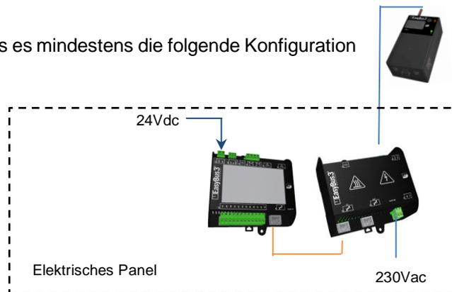
Das folgende Diagramm zeigt die Topologie des Hauptnetzes in ihrer maximalen Konfiguration.
