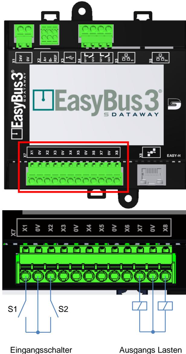
**Hinweis:** Die Eingangsschalter und Ausgangs Lasten sind als Beispiel dargestellt. Jeder Signalkontakt kann entweder im Eingangsmodus oder im Ausgangsmodus konfiguriert werden.
