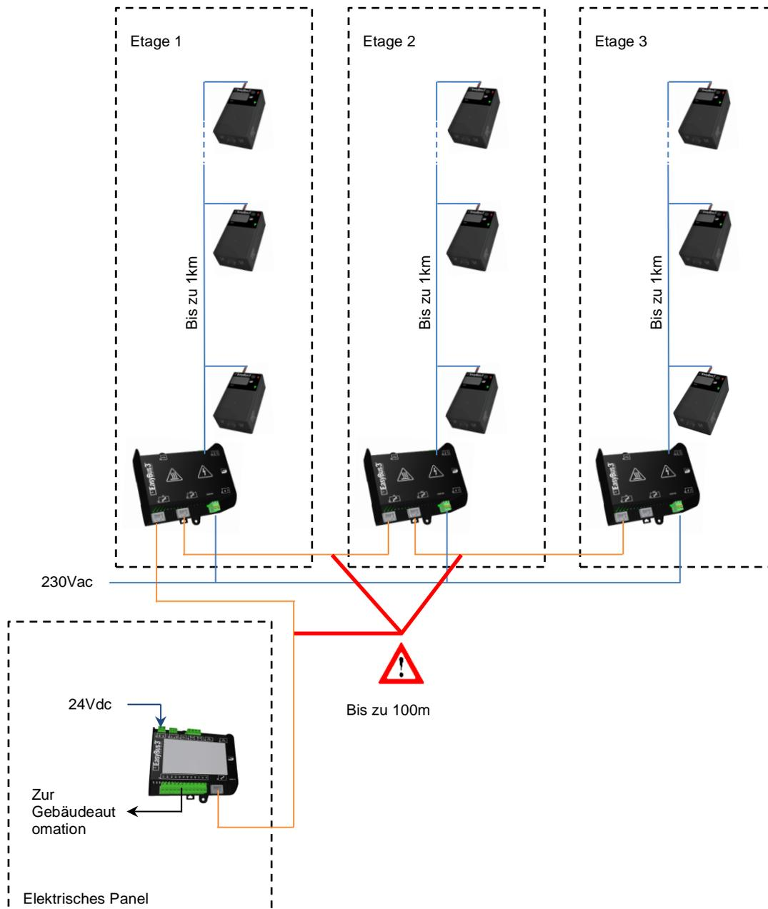
Es ist jedoch auch möglich, die Easy3-M-Module neben den Lüftungssystemen zu positionieren, wobei eine **maximale Entfernung von 100 Metern** zwischen dem Easy3-H und dem am weitesten entfernten Easy3-M einzuhalten ist.
