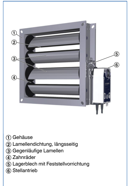
Schematische Darstellung JZ-HL-AL
