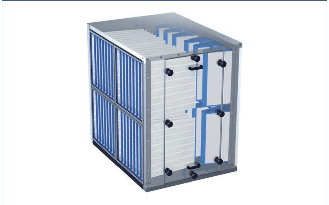
Beispiel für Variante UCA-2SPF mit Taschenfiltern als erste Filterstufe und Mini Pleat Filtereinsätze als zweite Filterstufe, z. B. M5-Filter als Vorfilter und F9-Filter als Endfilter.
