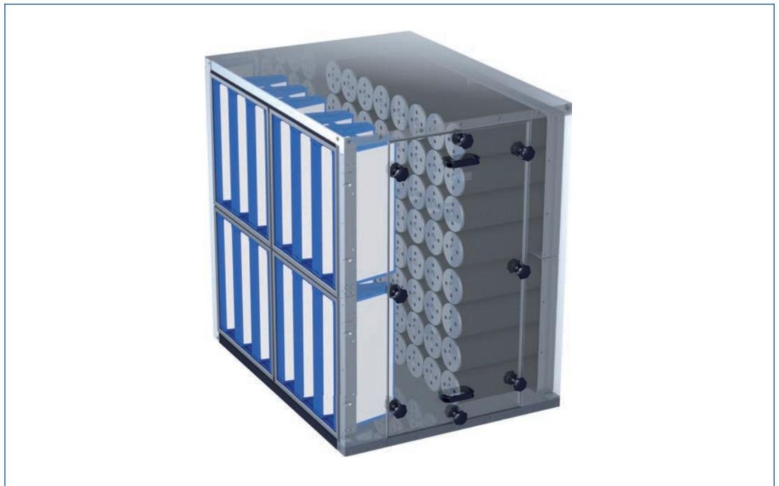
Beispiel für Variante UCA-2SAF mit Mini Pleat Filtereinsätzen als erste Filterstufe und Aktivkohle-Filterpatronen als zweite Filterstufe, z. B. F7-Filter als Vorfilter zum Schutz der nachgeschalteten Aktivkohle-Filterpatronen zur Adsorption von gasförmigen Stoffen.
