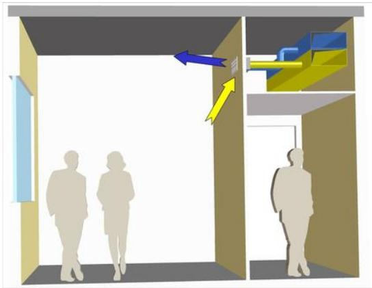
Kombinierter Zu- und Abluft-Wandluftdurchlass KUD2-ZLAL. Zuluft: Der obere Teil des Durchlasses ist mit steckbaren, allseitig verstellbaren Kugeldüsen bestückt. Abluft: Im unteren Teil des Durchlasses mit Lochperforierung.
