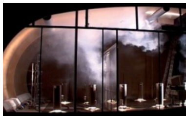
Tests de débit d'air : simulations dans le laboratoire de recherche & développement TROX
