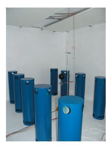
Es können auch thermische Versuche, z.B. Leistungsmessungen eines Kühlsegels / einer Kühldecke durchgeführt werden.
